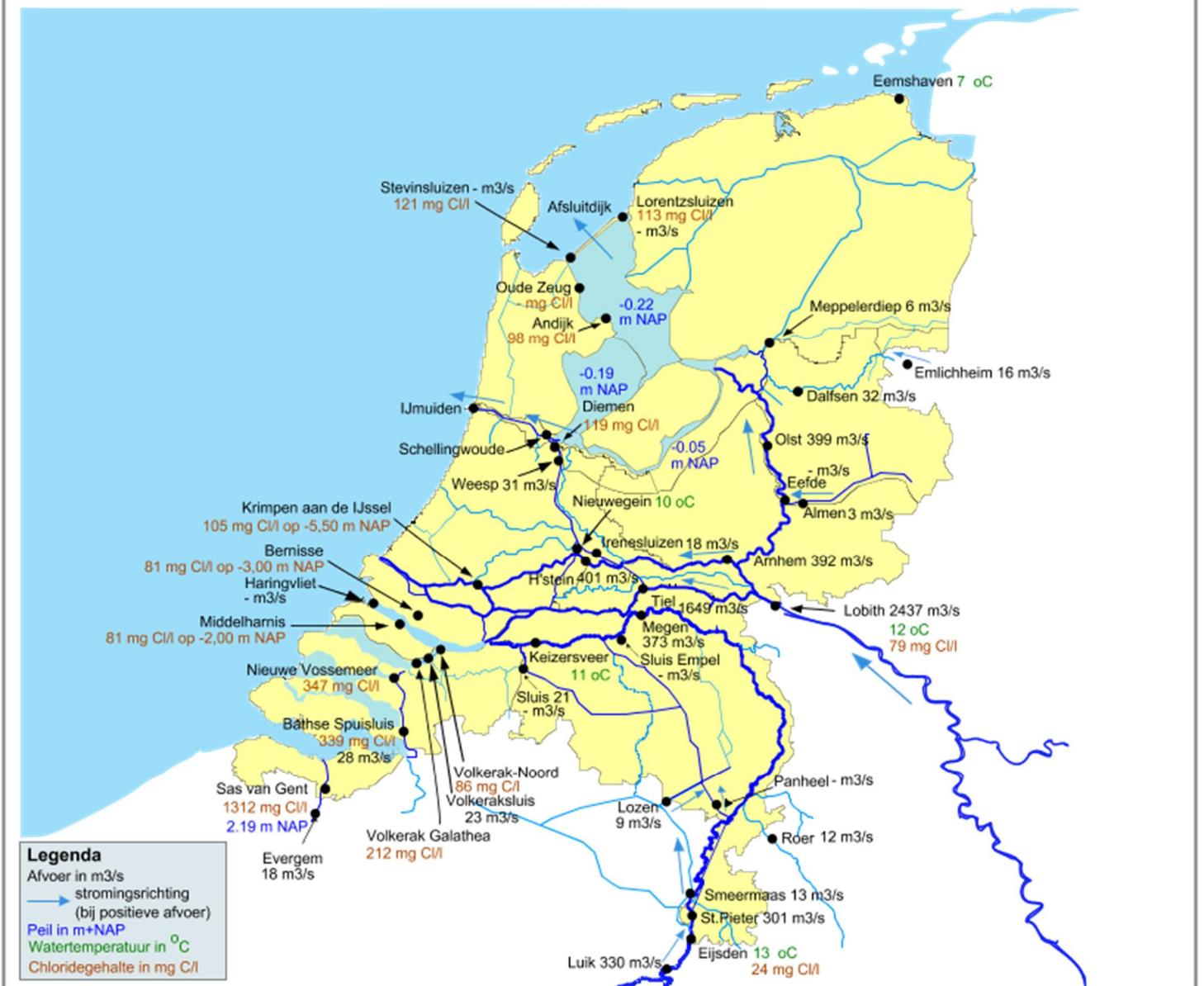
Figuur 3. Landelijk overzicht met metingen van stroomrichting, afvoer, waterpeil, watertemperatuur en zoutgehalten op diverse locaties.
