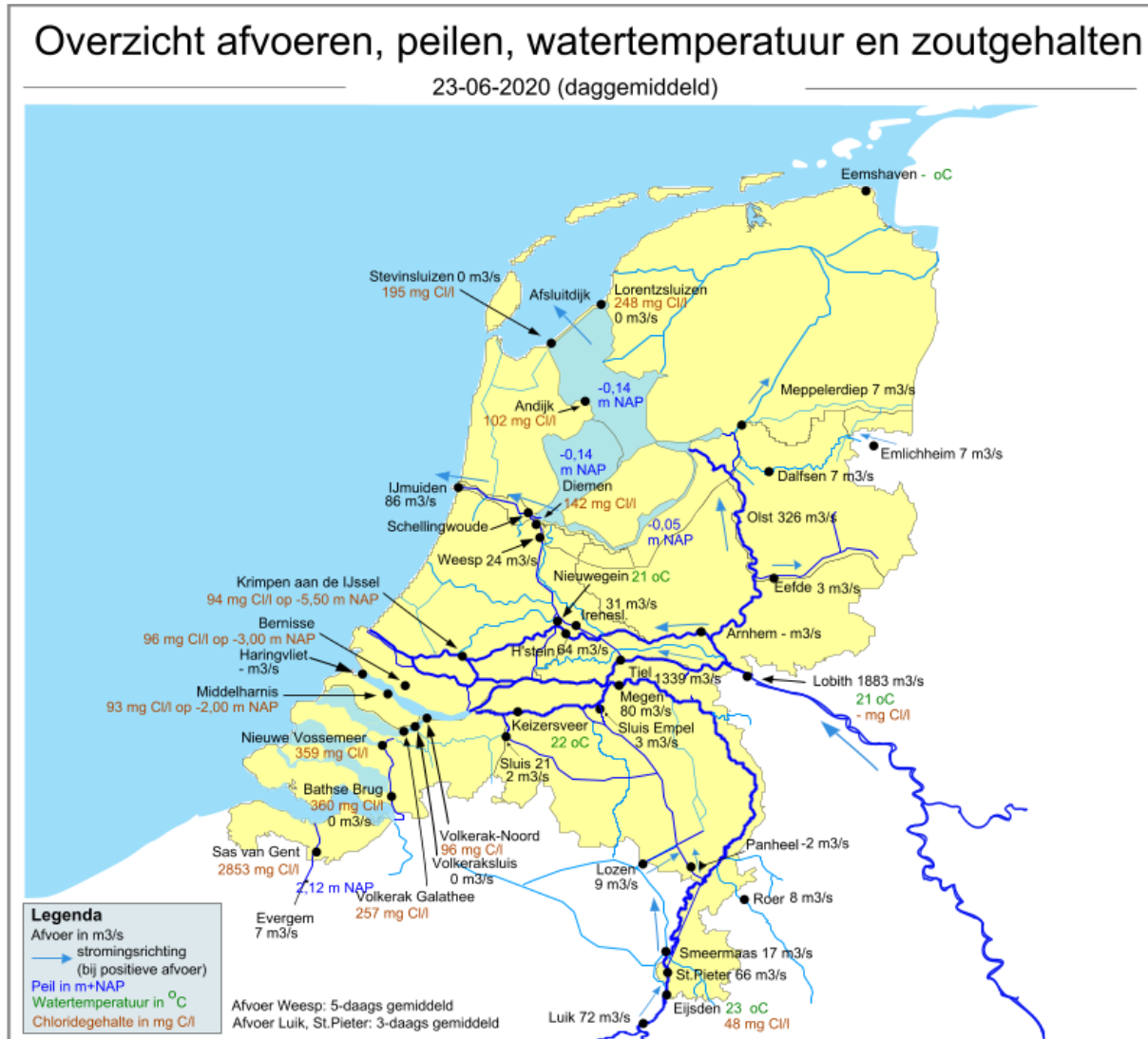
Figuur 3: Overzicht afvoeren, peilen, watertemperatuur en zoutgehalten, daggemiddelde 23 juni 2020 | Bron: WMCN
