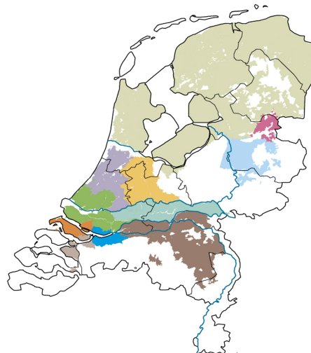
Figuur 2. Gebieden die in de huidige situatie grondwater ontvangen uit het hoofwatersysteem. Naar de wit gekleurde gebieden kan geen water uit Rijn of Maas worden aangevoerd.
