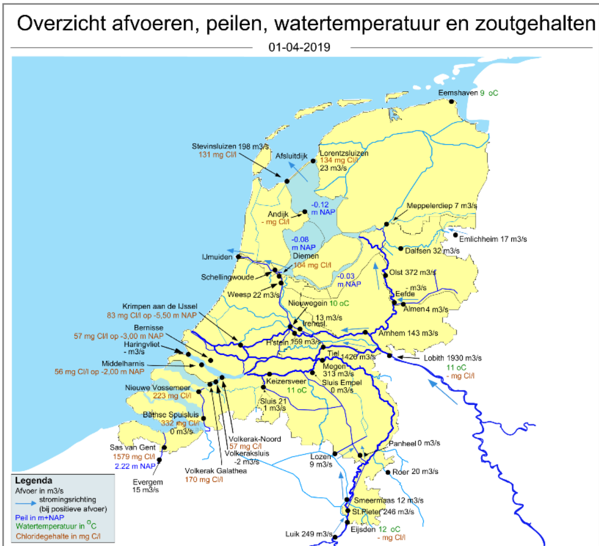
Figuur 1. Landelijk overzicht met metingen van stroomrichting, afvoer, waterpeil, watertemperatuur en zoutgehalten op diverse locaties.
