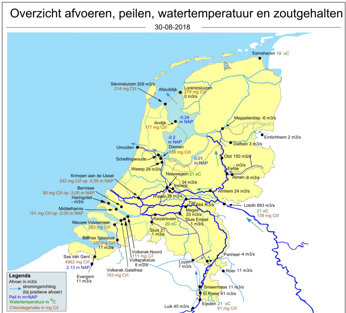
Figuur 3. Landelijk overzicht met metingen van stroomrichting, afvoer, waterpeil, watertemperatuur en zoutgehalten op diverse locaties.
